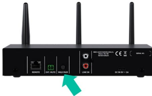
2. Se iniciará el proceso de descubrimiento, es decir, búsqueda de receptores disponibles. El indicador LED de Status parpadeará lentamente durante este proceso, que puede tardar varios segundos en completarse. Una vez emparejados los receptores con el WiLD-TX, pulse la tecla WiLD PAIR del panel posterior para detener el modo de emparejamiento.
