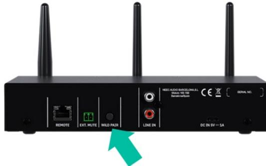
2. Le processus de détection, ou balayage des récepteurs disponibles, commencera. La LED d'état (status) clignote lentement pendant ce processus, qui peut prendre plusieurs secondes. Une fois les récepteurs appairés avec le WiLD-TX, appuyez à nouveau sur le bouton WiLD PAIR de la face arrière pour arrêter le mode d'appairage.
