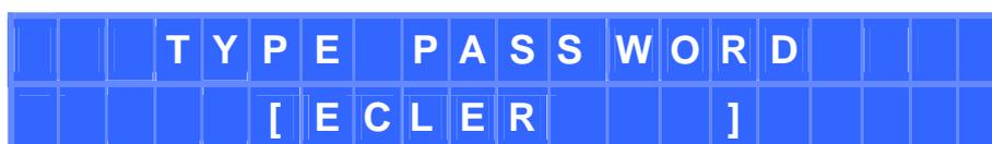
Mediante un control giratorio (ZA a ZB) se edita el carácter seleccionado, y mediante la tecla PARAMETER se selecciona el siguiente carácter a editar. Finalmente, se pulsa SHIFT + ENTER para validar la contraseña introducida.
