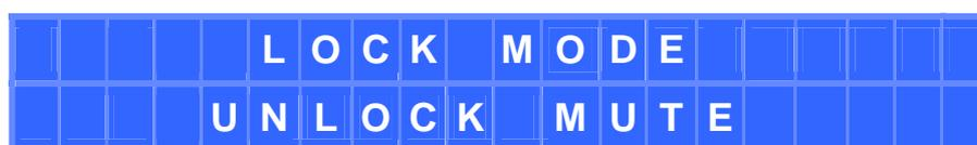
Mediante el control giratorio es posible cambiar el modo de bloqueo deseado y, a continuación pulsar SHIFT + ENTER para confirmar la selección. Si se selecciona uno de los tres modos protegidos mediante contraseña (LOCK ALL, UNLOCK OUTS ó UNLOCK INS&OUTS), la siguiente pantalla solicita introducir la contraseña de bloqueo:
