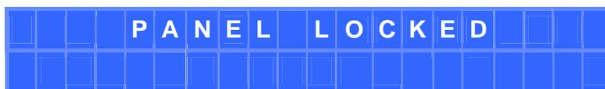
Para habilitar de nuevo los controles del panel frontal es preciso introducir la contraseña almacenada. Para ello, acceda al menú de bloqueo (teclas MENU derecha e izquierda simultáneamente, durante 2 segundos). Se mostrará la siguiente pantalla:
