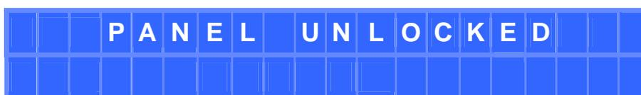
El equipo quedará temporalmente desbloqueado, hasta que transcurran 2 minutos sin actividad sobre el panel frontal o bien se acceda de nuevo al menú de bloqueo (MENU derecha e izquierda simultáneamente, durante 2 segundos) para confirmar o modificar el modo de bloqueo, en cuyo caso se volverá a solicitar la contraseña (la misma o una nueva), que será activa a partir de su validación (SHIFT + ENTER).
