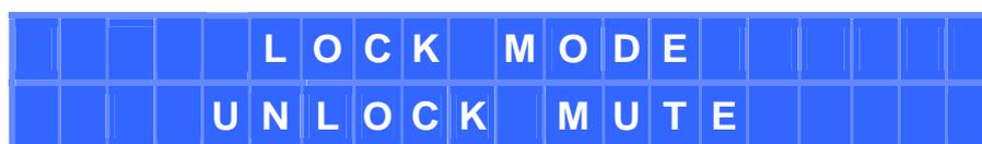
Mit Hilfe des Drehreglers kann der Sperrmode geändert werden. Danach zur Bestätigung der Auswahl SHIFT + ENTER drücken. Wird einer der drei passwortgeschützten Modi gewählt (LOCK ALL, UNLOCK OUTS oder UNLOCK INS&OUTS), so öffnet sich ein Fenster, in dem die Eingabe des Sperr-Passworts verlangt wird:
