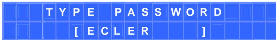
Mit Hilfe eines Drehreglers (ZA bis ZB) wird das ausgewählte Zeichen eingegeben, und mit Hilfe der Taste PARAMETER wird das nächste zu bearbeitende Zeichen ausgewählt. Abschließend wird durch Drücken der Tasten SHIFT + ENTER das eingegebene Passwort bestätigt.
