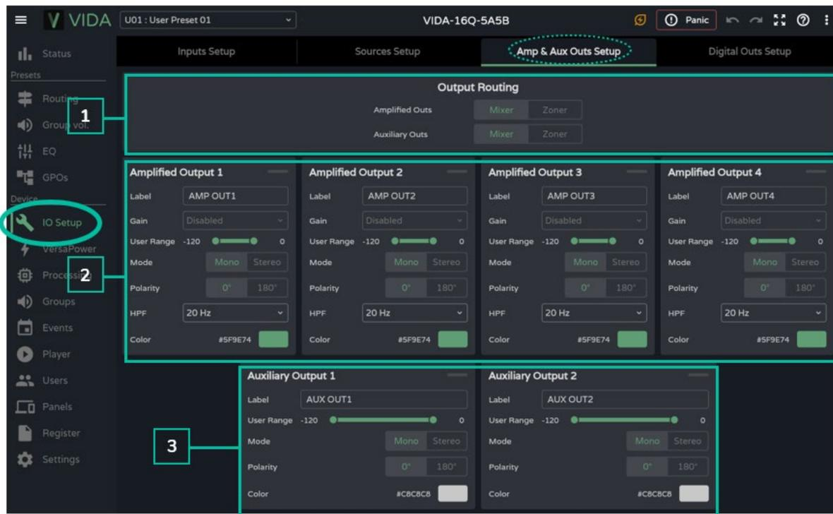
1. **Output routing:** selección del modo de enrutamiento de las señales amplificadas y auxiliares.
