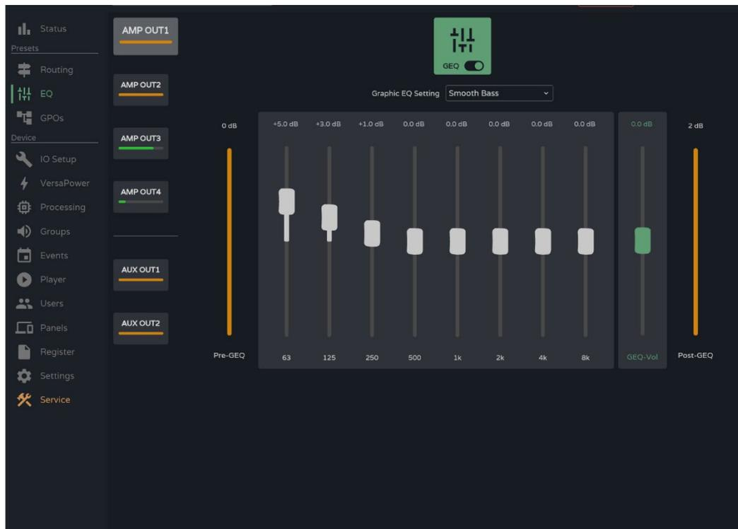
Ecualizador gráfico (GEQ) de 8 bandas independiente para cada una de las salidas amplificadas y auxiliares.
