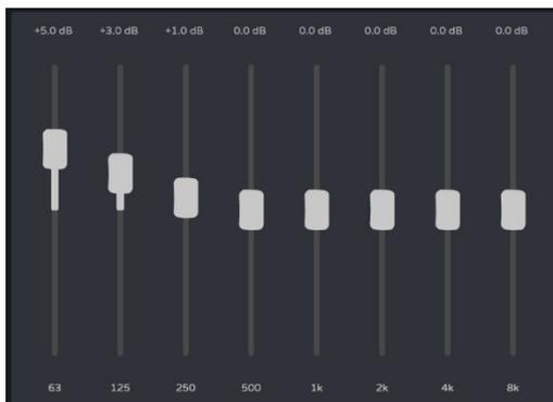
**Ajuste de la ganancia** de las bandas del GEQ.
