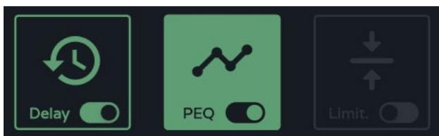
Gestión de los módulos de procesado. Permite la selección de los módulos, para visualización y configuración de parámetros, así como habilitar y deshabilitar dicho módulo de forma rápida, sin necesidad de abrir su página de configuración.
