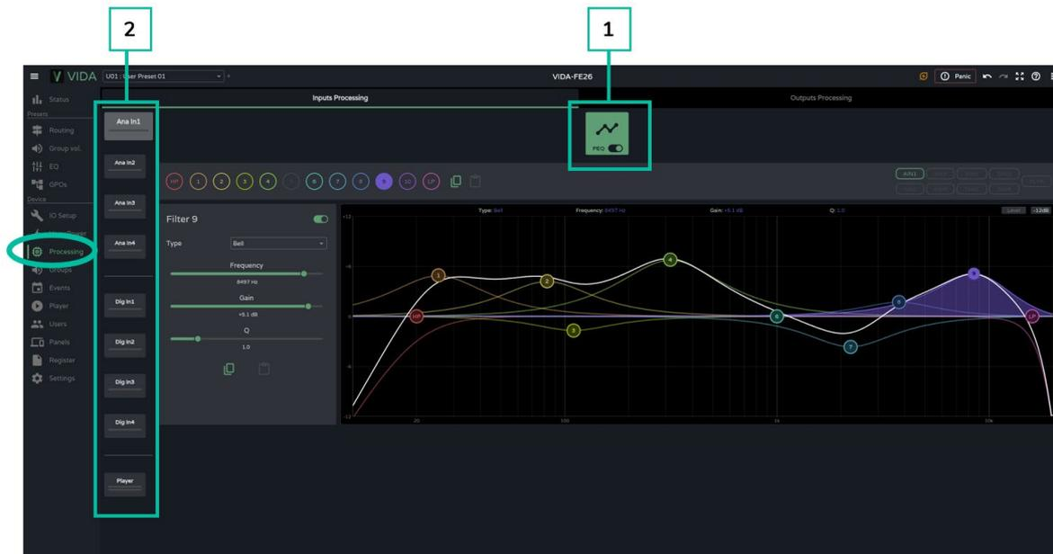
1. Ecuador paramétrico (PEQ): 2 filtros de crossover y 10 filtros completamente configurables.
