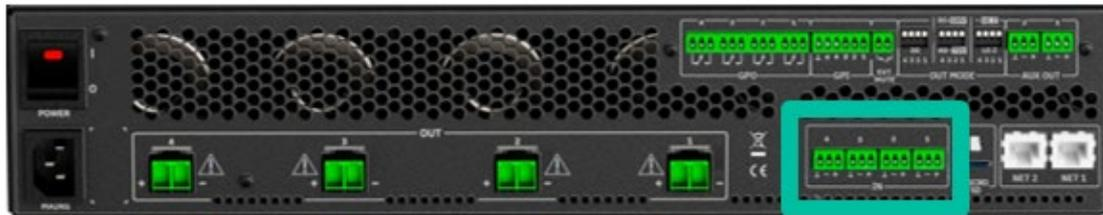
Los conectores de entrada de señal son bloques de terminales de tornillo de 3 posiciones. El cableado es:
