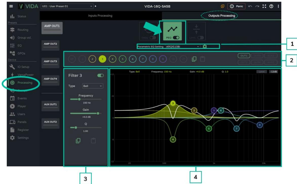
**La configuración del PEQ de cada salida se guarda en los ajustes de dispositivo. No se guarda en los presets de usuario a diferencia del GEQ de usuario.**
