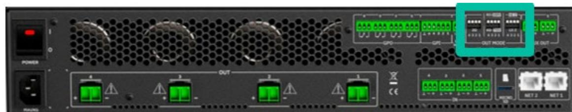
Seleccione el modo de funcionamiento adecuado para no dañar los altavoces. **No conecte nunca cargas inferiores a 2 ohmios cuando trabaje en modo de baja impedancia.**
