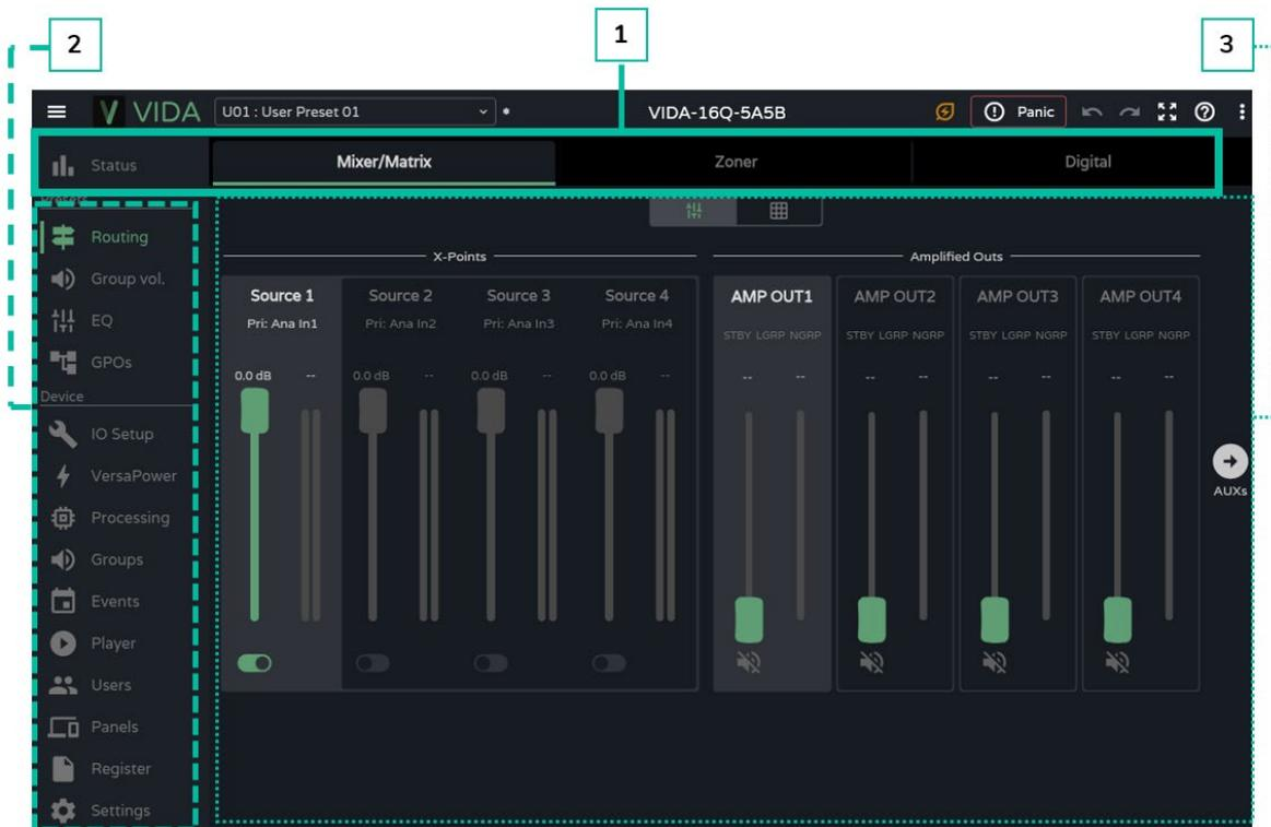
1. **Barra de aplicación:** contiene información relevante, botones de acción rápida, además del menú de configuración de la aplicación.
