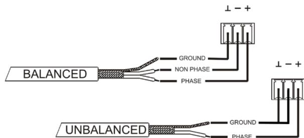
**!** Para una **conexión no balanceada** cortocircuite la clavija ⊥ con la clavija - como se muestra en la imagen de arriba.
