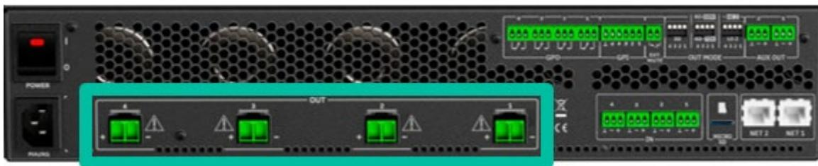
**Respete siempre la polaridad relativa de las salidas (+ y - en cada conector de salida), del cableado y de los altavoces.**
