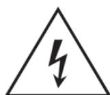
El símbolo del relámpago con una flecha en la punta y dentro de un triángulo equilátero, tiene el propósito de alertar al usuario de la presencia de un voltaje peligroso y sin aislar dentro del aparato, y de una magnitud tal que puede constituir riesgo de descarga eléctrica para las personas.
