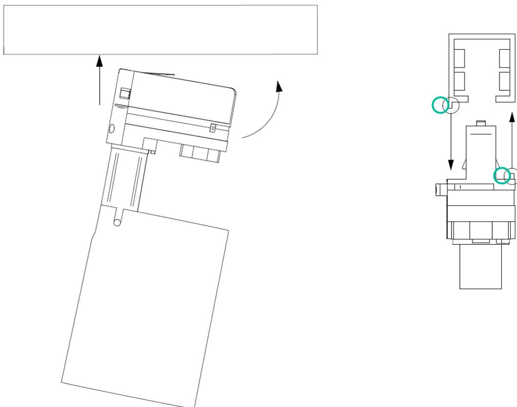
Conexión a un carril de iluminación GLOBAL Trac Pro / Eutrac (sistema de carril de iluminación de tres circuitos)
