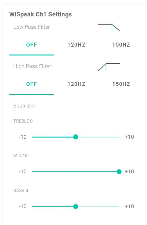
Cada canal de WiSpeak, CH1 y CH2, tiene una sección dedicada e independiente que incluye exactamente el mismo conjunto de características de procesamiento y controles. La imagen de arriba muestra la sección de ajustes del CH1.
