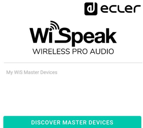
Durch Anklicken des Schaltfeldes **DISCOVER MASTER DEVICES** wird der Scanprozess nach verfügbaren Mastergeräten (CORE-Sendern) in Gang gesetzt, nach dessen Durchführung alle Ecler Bluetooth-Geräte angezeigt werden, die in der Vergangenheit mit dem Smart-Gerät gepairt wurden:
