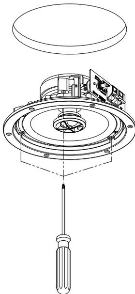
Insérez le haut-parleur dans l'orifice réalisé. Tenir l'appareil d'une main et le mettre en place en vérifiant que les languettes rotatives restent en retrait.
