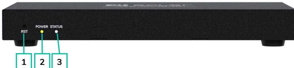
1. **RST (RESET-Taste):** Halten Sie diese Taste gedrückt (ca. 10 Sekunden), bis die Status-LED zu blinken beginnt: der Controller wird automatisch zurückgesetzt.
