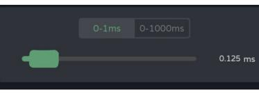
**Einstellung der Verzögerung** mittels Fader oder durch Eingabe des numerischen Werts:
