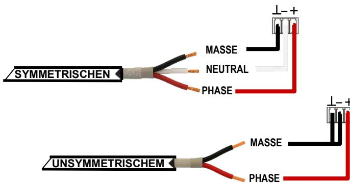
**⚠️** Bei **unsymmetrischem Anschluss** den Pin  $\perp$  mit dem Pin - wie auf dem Bild dargestellt - kurzschließen.
