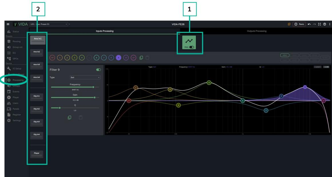
1. **Parametrischer Equalizer (PEQ):** 2 Crossover-Filter und 10 vollständig konfigurierbare Filter
