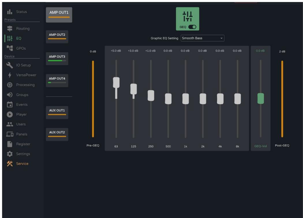
Unabhängiger grafischer 8-Band-Equalizer (GEQ) für jeden der verstärkten Ausgänge und der Hilfsausgänge.
